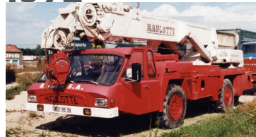
GB18 Haulotte, première «City crane» au monde - vitesse élevée de déplacement, mise en oeuvre rapide et cabine élévatrice.
